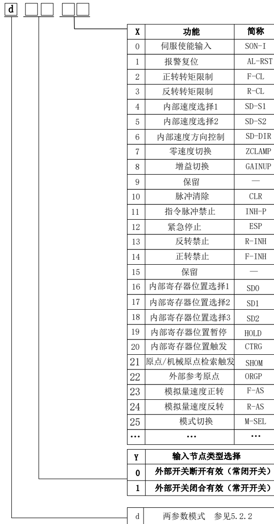
图 8.1.1 可编程输入端子功能设定示意图
